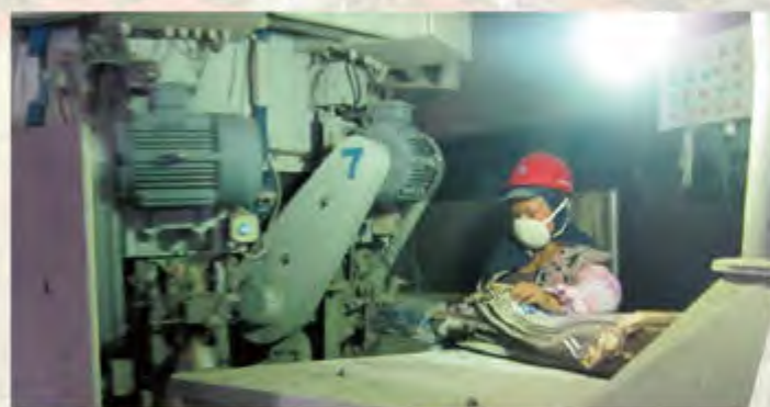
株洲公司通过对包装机密封、建设装包收尘系统控制粉尘无组织排放
